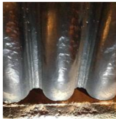
육성 용접부 불량에 의한 침식마모(좌) 및 직관도 불량에 의한 침식마모(중, 우)
