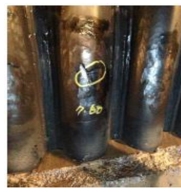
육성 용접부 불량에 의한 침식마모(좌) 및 직관도 불량에 의한 침식마모(중, 우)
