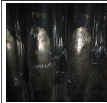
육성 용접부 불량에 의한 침식마모(좌) 및 직관도 불량에 의한 침식마모(중, 우)
