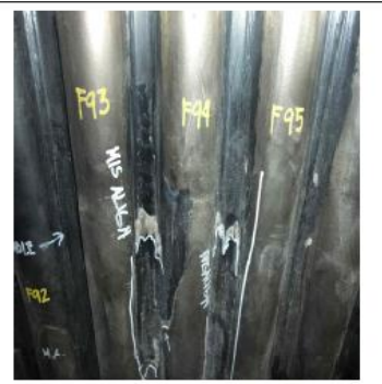
육성 용접부 불량에 의한 침식마모(좌) 및 직관도 불량에 의한 침식마모(중, 우)
