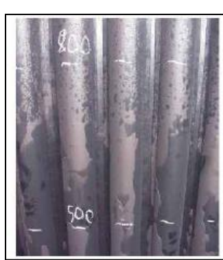
육성 용접부 불량에 의한 침식마모(좌) 및 직관도 불량에 의한 침식마모(중, 우)
