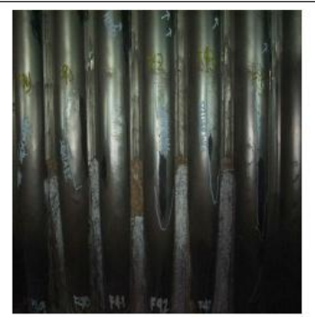
육성 용접부 불량에 의한 침식마모(좌) 및 직관도 불량에 의한 침식마모(중, 우)
